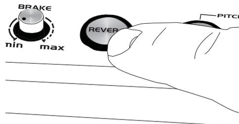
Mit der Taste [**REVERSE**] können Sie die Drehrichtung umschalten. Drücken Sie dazu jeweils kurz die Taste. Bei eingeschaltetem Rückwärtslauf leuchtet die Taste.
