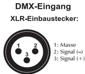
Wenn Sie Controller mit dieser XLR-Belegung verwenden, können Sie den DMX-Ausgang des Controllers direkt mit dem DMX-Eingang des ersten Gerätes der DMX-Kette verbinden. Sollen DMX-Controller mit anderen XLR-Ausgängen angeschlossen werden, müssen Adapterkabel verwendet werden.
