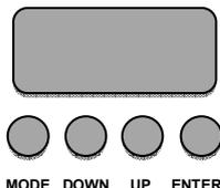
Durch Drücken der MODE-Taste können Sie sich im Hauptmenü bewegen. Durch Drücken der UP/DOWN-Taste können Sie die Auswahl verändern. Bestätigen Sie jede Änderung durch Drücken der ENTER-Taste. Der jeweilige Modus kann durch die MODE-Taste verlassen werden. Die jeweiligen Funktionen werden im Folgenden aufgeführt.
