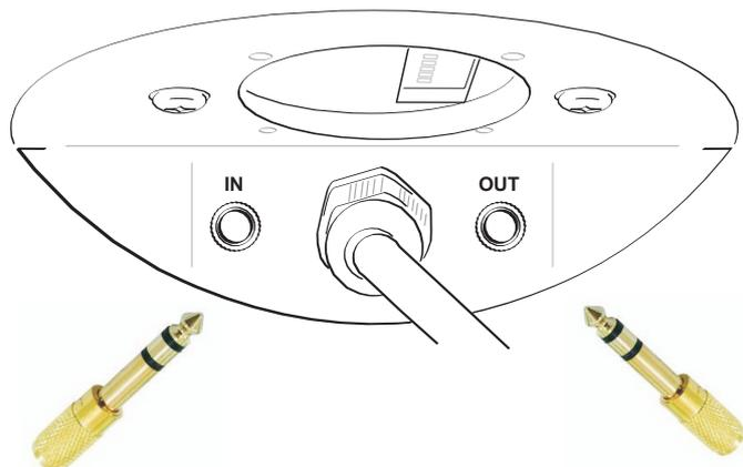
Die Steckverbindung zwischen den einzelnen Geräten geht über spezielle Verbindungskabeln mit stereo Klinkenstecker, die im Lieferumfang enthalten sind.
