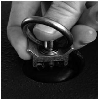
Führen Sie den Flachkopf des Haltebolzens in die Führung des Flugpunktes.
