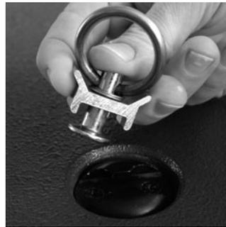
... und drücken Sie die Arretierhilfe gegen die Federspannung nach oben.
