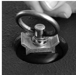
Lassen Sie die Arretierhilfe los, wenn sich die Zurröse in der Mitte des Flugpunktes befindet. Achten Sie darauf, dass die Arretierhilfe einrastet.
