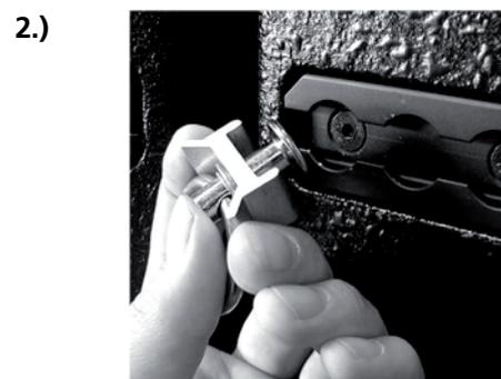
... und drücken die Arretierhilfe gegen die Federspannung nach oben.
