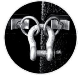
Eine 'allsafe JUNGFALK' Flugschiene darf maximal mit 73 kg belastet werden. Daher muss die Last beim Abspannen der Systeme auf mehrere Flugschienen verteilt werden.
