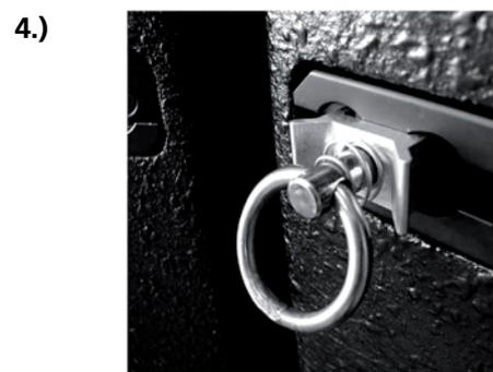
Lassen Sie die Arretierhilfe los, wenn sich die Zurröse über den Zungen befindet. Achten Sie darauf, dass die Arretierhilfe einrastet. Und überprüfen Sie unbedingt den festen Sitz.
