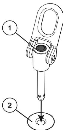
Drücken Sie den Entsperrknopf 1 und setzen Sie den K&F Kugeltragbolzen vollständig in den Flugpunkt 2 ein.
