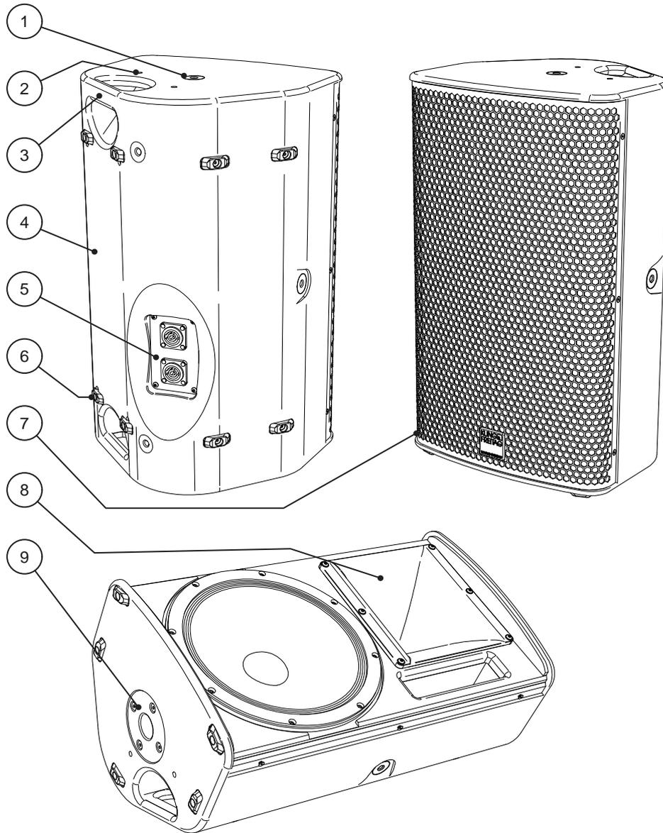
1. **(5x) Flug- und Sicherungspunkt K&F 'VariPoint'** zur Verwendung mit dem Kugeltragbolzen 'K&F Lifting Pin', K&F Ringschraube oder weiterem K&F Zubehör.
