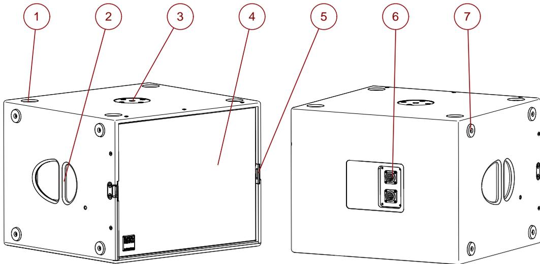
1. **(4x) Stapelfußmulden** auf Gehäuseoberseite, zum Stapeln gleicher Gehäuse
