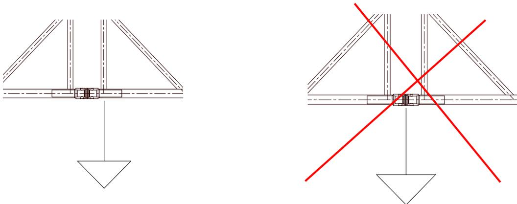
Alle Lasten sind gleichmäßig auf beide Gurte zu verteilen.
